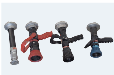
Lances à jet creux (marquage en couleur uniforme des poignées pour indiquer le volume d'eau)
