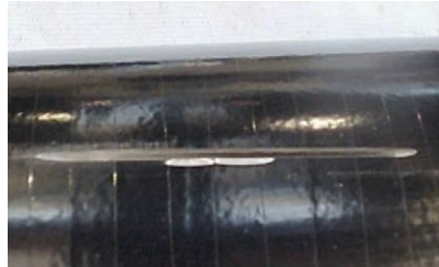
Entailles sur une bouteille: critique
