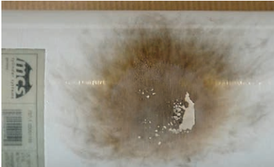
Traces de feu sur une bouteille: non critique
